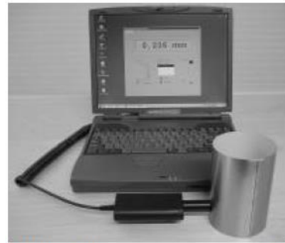
Fig.2 Medición del espesor de la hoja en un cuerpo de lata con CAT 05 conectado a una computadora portátil
